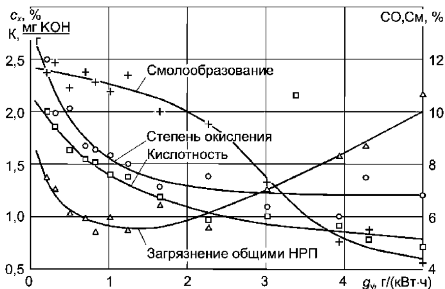
Рисунок 2 – Зависимость старения масла от угля в судовом дизеле
