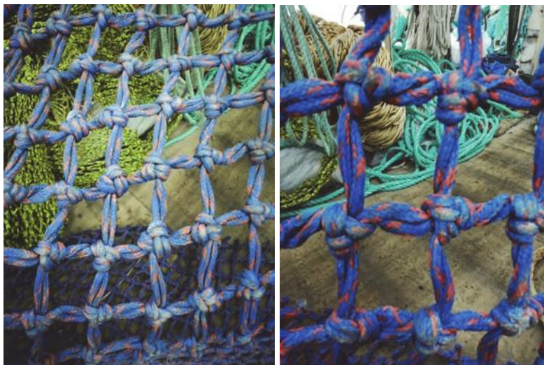
Рисунок 2 – Деформация ячеи в селективной вставке в процессе эксплуатации
