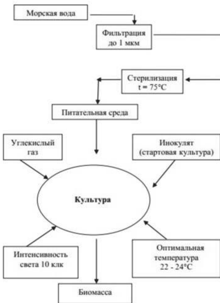
Схема подготовки питательной среды и массового культивирования микроводорослей [13]
