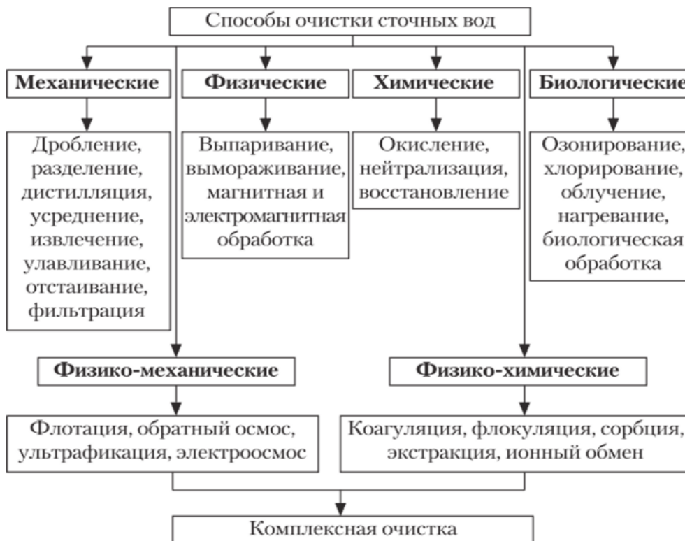
Рисунок 1 – Методы очистки сточных вод
