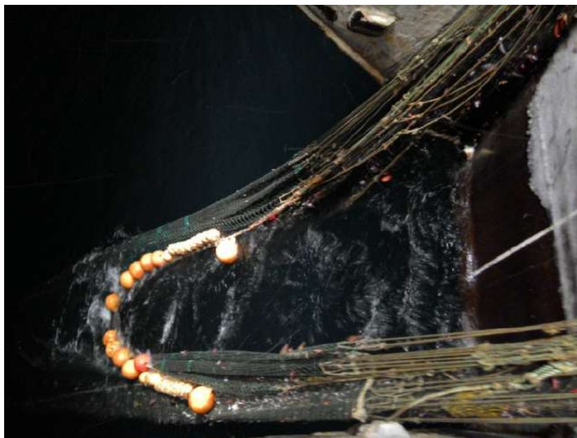
Рис. 1. Верхняя подбора и крылья донного трала 65,4/49,6 м с канатными элементами
