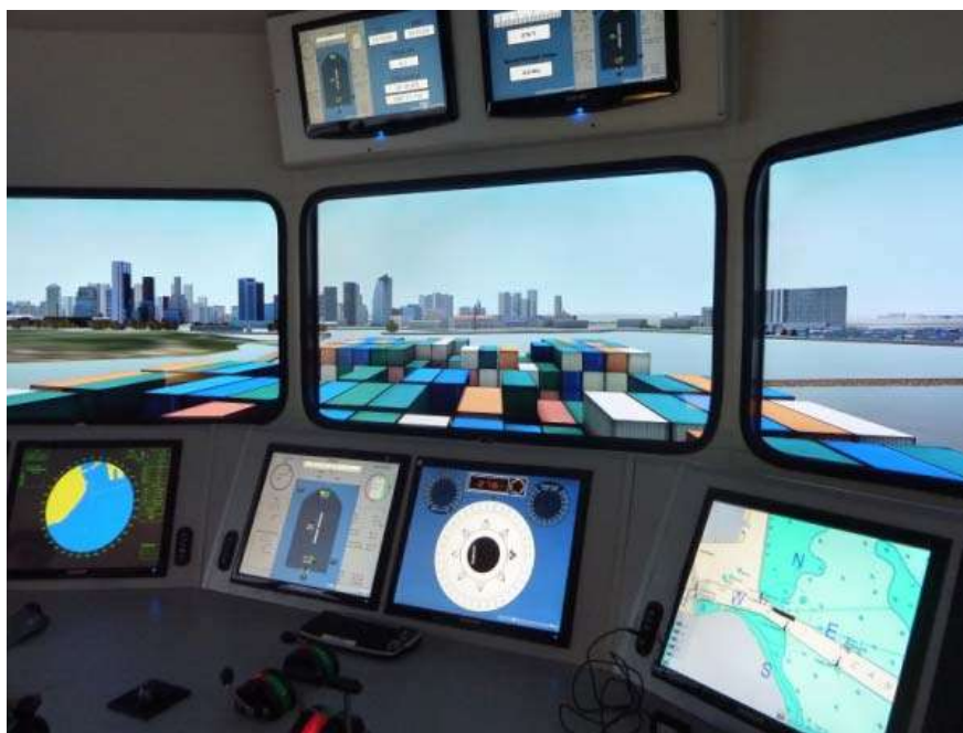
Рис. 2. Информационные дисплеи на ходовом мостике
