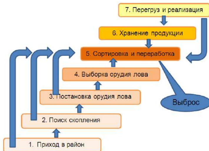
Рис. 2. Схема промыслового цикла рыбодобывающего судна, оборудованного технологической линией по переработке, заморозке и упаковке улова
