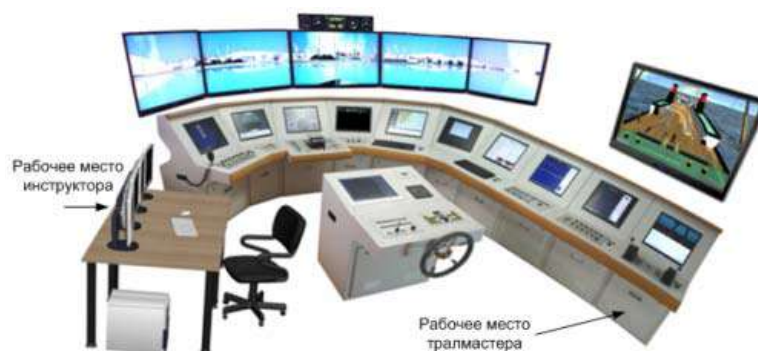
Рис. 1. Интегрированная версия тренажера ППРОЛ-3D применяется в составе рыбопромыслового тренажера «РПТ-4000» [6]
