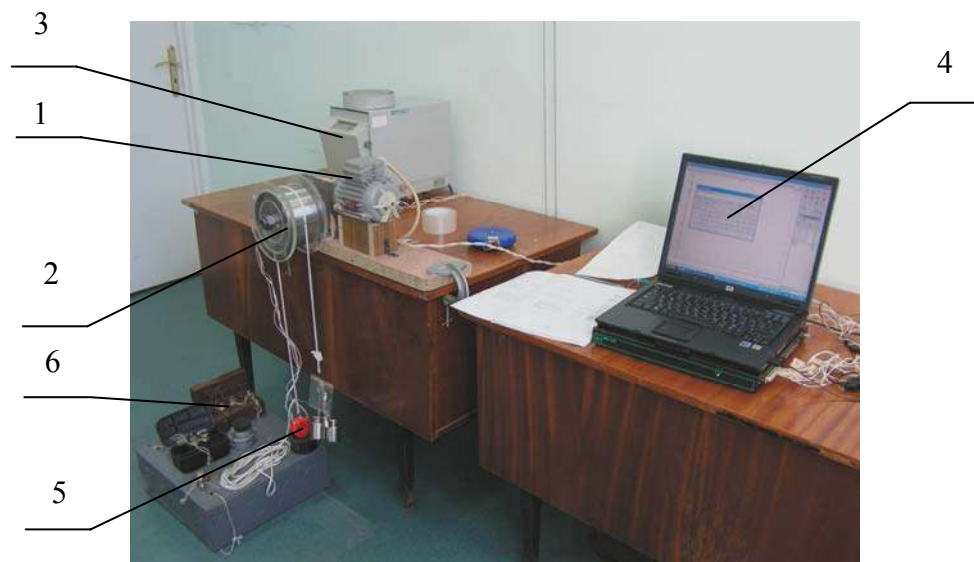
Рис. 2. Экспериментальная установка: 1 – мотор-редуктор; 2 – съемный барабан; 3 – электронные весы; 4 – тензостанция МС-200; 5 – тензодатчик; 6 – разновесы
