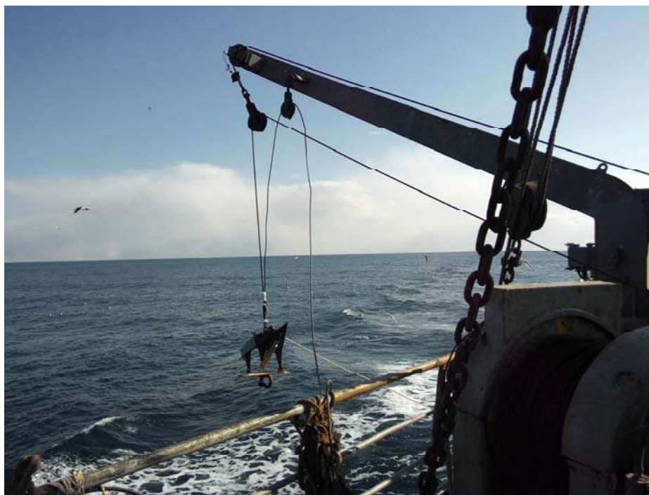
Рис. 2. Параван с гидрофоном на грузовой стреле
