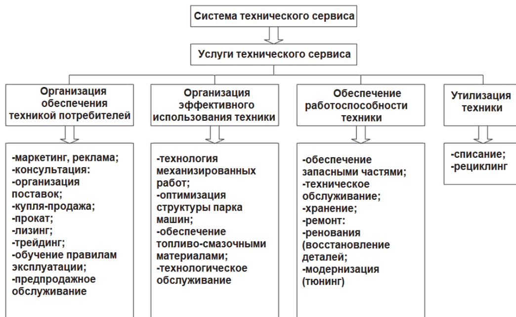
Рисунок 1 – Технический сервис в системе инженерно-технического обеспечения
