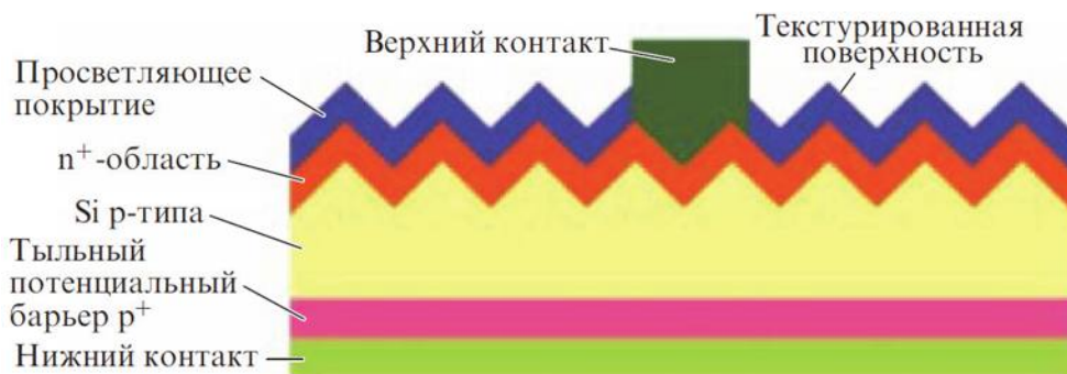
Схематическое изображение солнечного элемента на основе кремния
