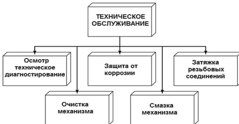
Рисунок 2 – Содержание работ по техническому обслуживанию оборудования
