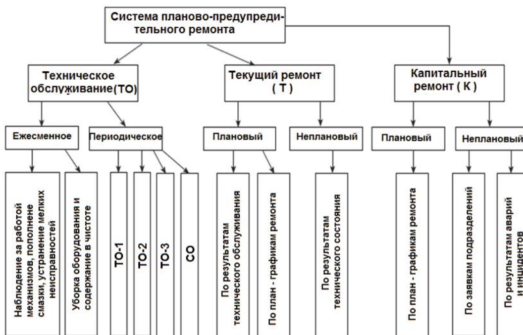
Рисунок 1 – Дифференциация работ по системе планово-предупредительного ремонта
