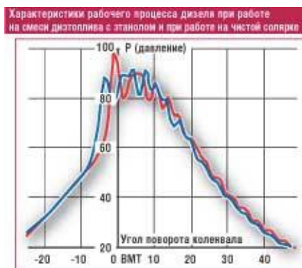
Характеристики рабочего процесса дизеля при работе на смеси дизтоплива с этанолом и при работе на чистом дизтопливе
