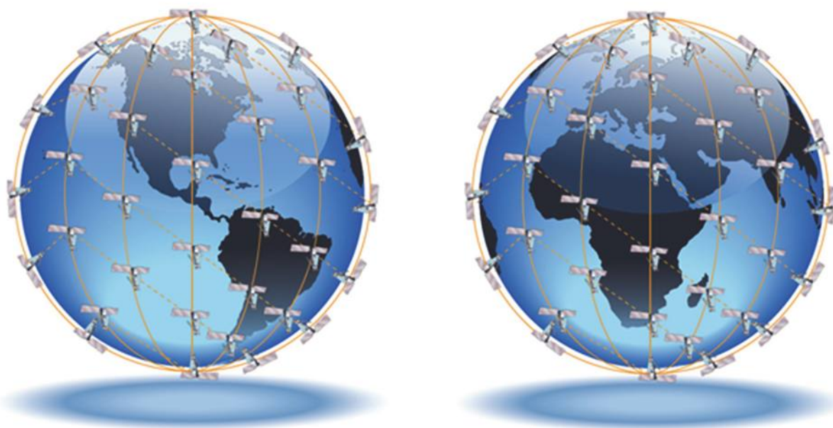
Рисунок 2 – Спутники системы связи «Иридиум»
