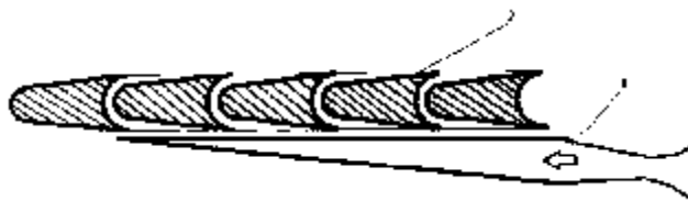
Рисунок 1 – Схема ступени СПБГТУ с большим относительным шагом рабочих лопаток: 1 – сопло; 2 – рабочее колесо
