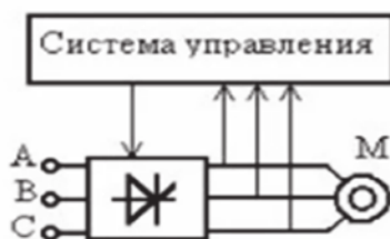
Рисунок 2 – Преобразователь частоты с непосредственной связью
