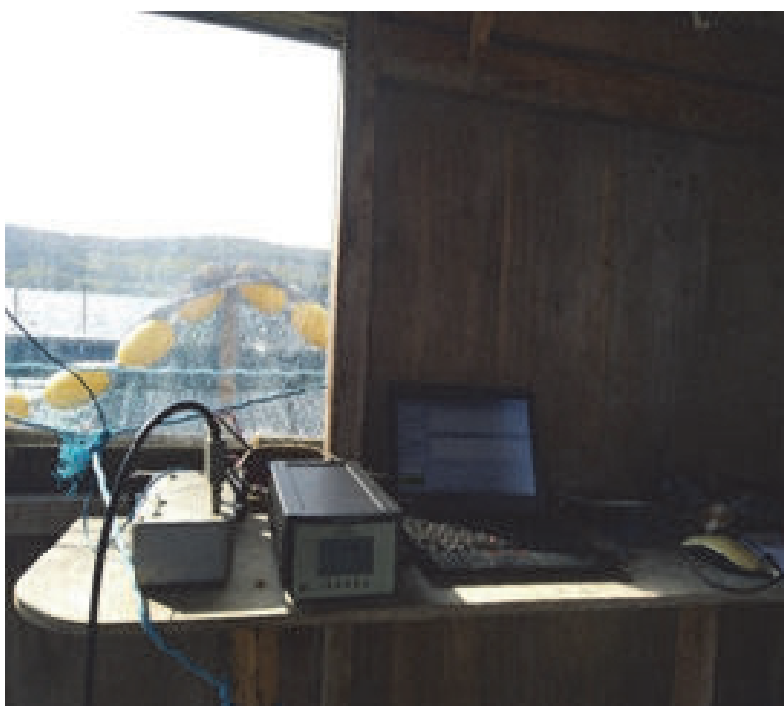
Рисунок 2 – Аппаратура, используемая для регистрации акустических сигналов и шумов, размещенная в павильоне. Слева направо: согласующее устройство и устройство оцифровки сигналов, 4-канальный усилитель 2693-OS4 компании «Брюли и Кьер», персональный компьютер
