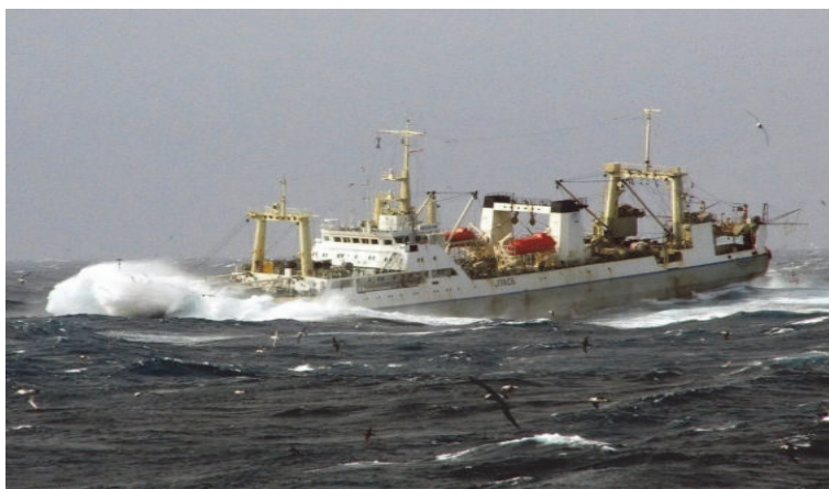
Рисунок 1 – Слеминг на встречной волне траулера типа «Пулковский Меридиан»
