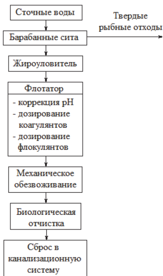
Рисунок 2 – Схема очистки сточных технологических вод на АО «Южморрыбфлот»
