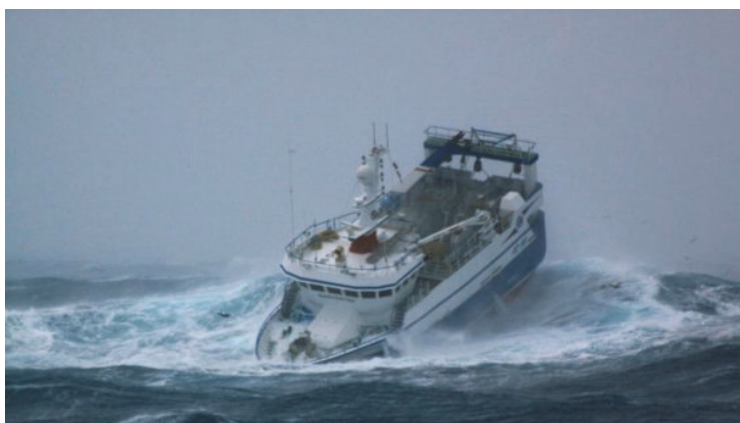
Рисунок 2 – Слеминг с оголением кормовой оконечности траулера «Тамозh»
