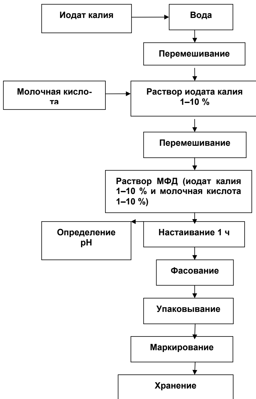
Рис. 6. Технологическая схема получения МФД
